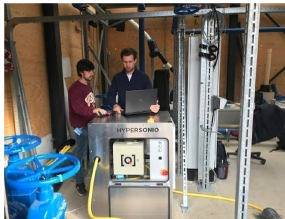
Figuur 2: Duurtest met de prototype EIS-sensor.
