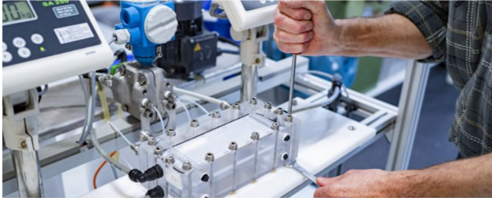
Figuur 4: Proefopstelling voor het snel meten van microbiologische waterkwaliteit.
