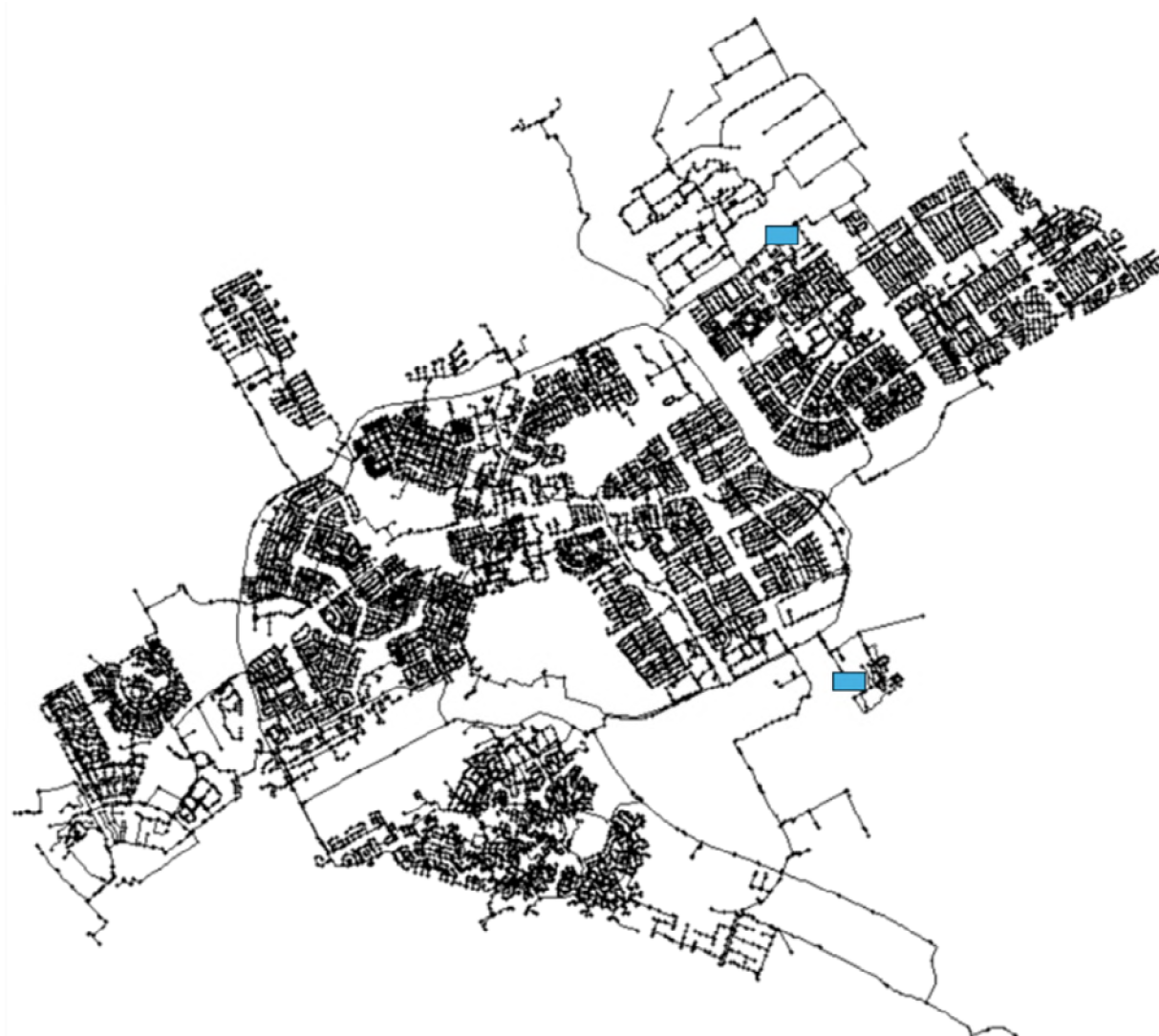
Figuur 27. Leidingnetmodel van Almere. De blauwe vierkanten zijn de leverpunten.
