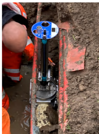
Figuur 19. (links) Thermistors voor bodemtemperatuurmetingen, aangestuurd door een 'meettegel'. (rechts) Geïnstalleerde Smart probe voor watertemperatuurmetingen.
