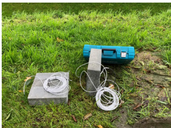
Figuur 19. (links) Thermistors voor bodemtemperatuurmetingen, aangestuurd door een 'meettegel'. (rechts) Geïnstalleerde Smart probe voor watertemperatuurmetingen.
