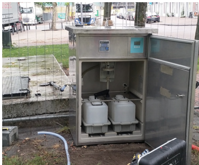
Figuur 7: Automatische monstersnemer voor rioolwatersurveillance..
