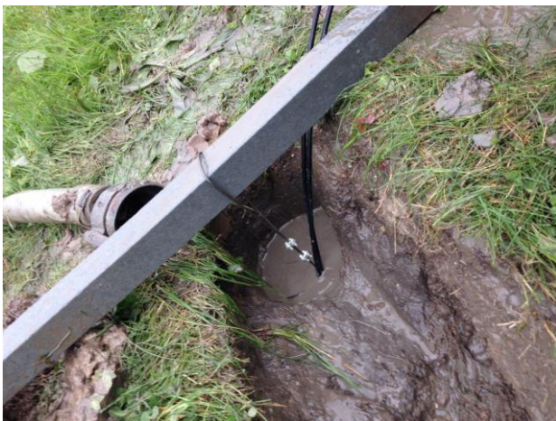
Foto: glasvezelkabel in bodem voor metingen (bron: KWR)
