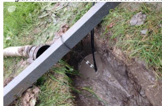
Figuur 4.2: Foto: glasvezelkabel in bodem voor metingen (bron: KWR)
