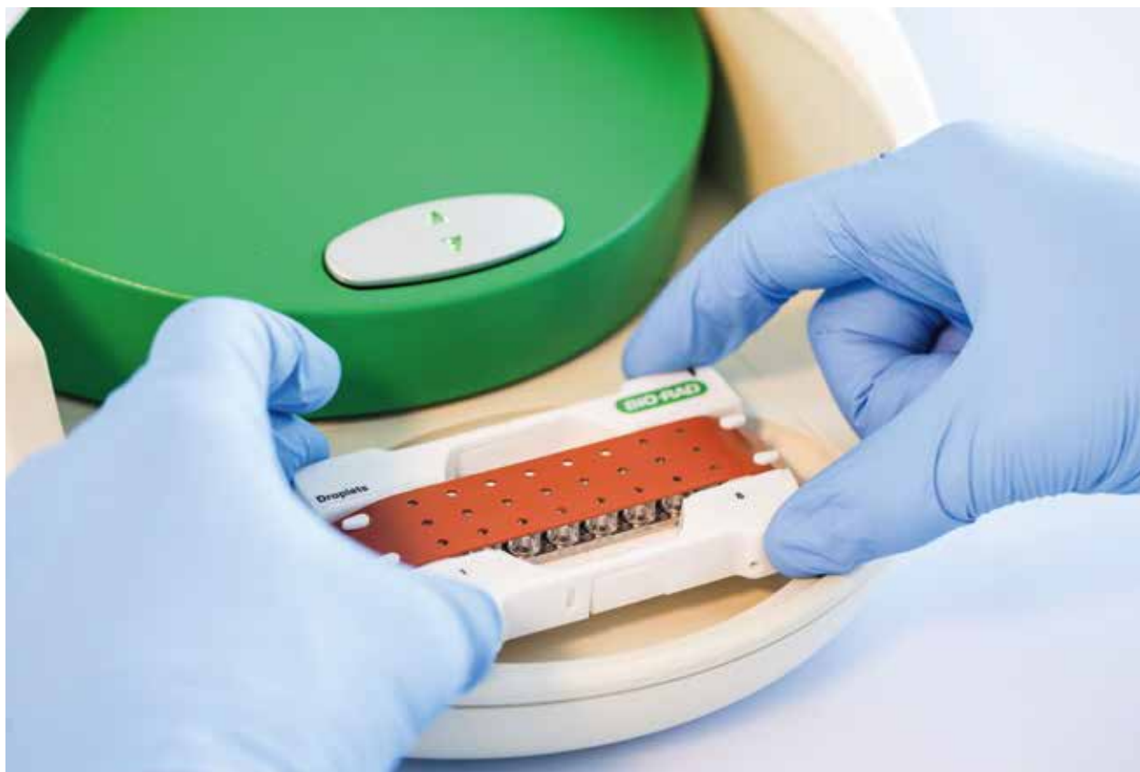
Afbeelding 2. Digital droplet RT-PCR voor het aantonen van HAV in rioolwater
