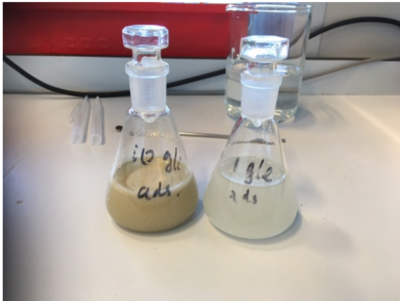
Figuur 7: Suspensies van het adsorbens in demiwater na sonificatie, gebruikt voor de dosering
