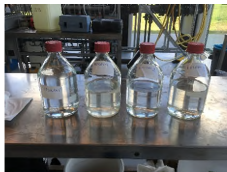
Figuur 8: Opvang van het water van de kolommen tijdens het experiment en de flessen met het monstermateriaal op de laatste dag (respectievelijk influent en kolom 1, 2 en 3)
