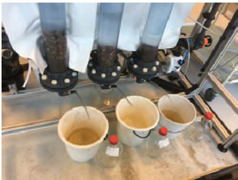
Figuur 8: Opvang van het water van de kolommen tijdens het experiment en de flessen met het monstermateriaal op de laatste dag (respectievelijk influent en kolom 1, 2 en 3)
