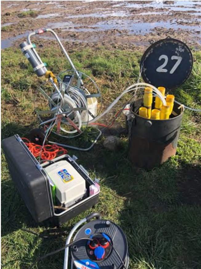
Bemonsteringopstelling van grondwater op locatie voor het meten van de chemische kwaliteit en de biologische samenstelling door middel van DNA-technieken.
