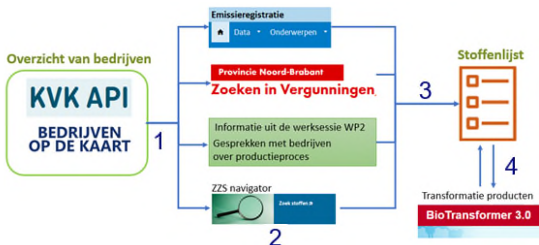
Figuur 2.4 overzicht bronopsporingsmethodiek en verkrijging van een relevante suspectlijst op basis van KvK informatie of Bedrijven op de kaart (Wesdorp, Van Driezum, Passier & Krystek, 2025)
