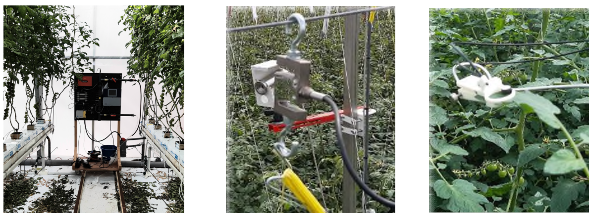
Figuur 3: Voorbeelden van sensorinstallaties bij Tomatoworld in 2022. Van links naar rechts: Sendot mobiele waterkwaliteitsmeetopstelling, Gremon Trutina plantgewicht meting, Sendot Leafclip fotosynthese sensor.
