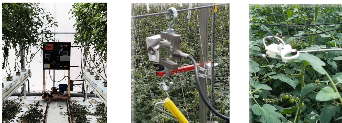
Figuur 2: Voorbeelden van sensorinstallaties bij Tomatoworld in 2022. Van links naar rechts: Sendot mobiele waterkwaliteitsmeetopstelling, Gremont Trutina plantgewichtmeting, Sendot Leafclip fotosynthesesensor.
