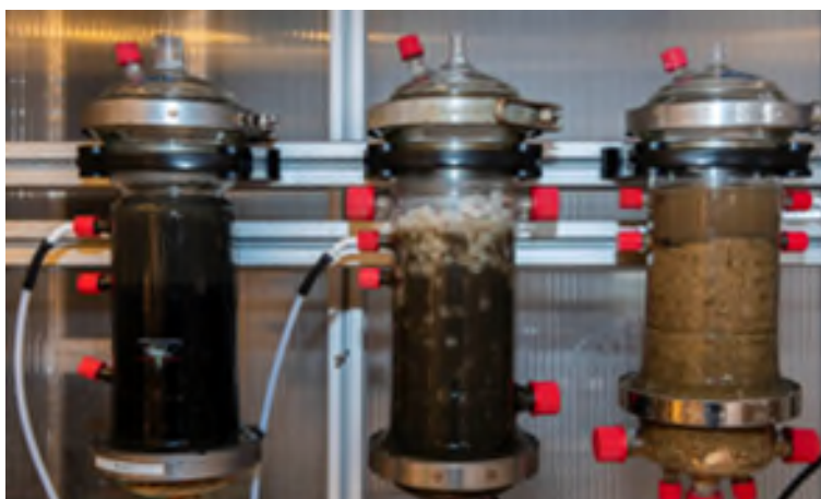
Drie configuraties biologische reactoren, die zijn getest als mogelijke eerste reactor in de BO3B-technologie. Detail biologische reactor.
