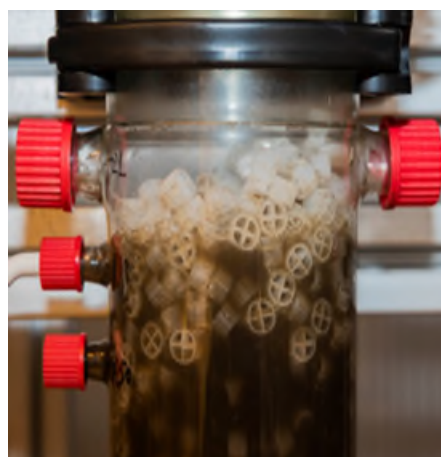
Drie configuraties biologische reactoren, die zijn getest als mogelijke eerste reactor in de BO3B-technologie. Detail biologische reactor.
