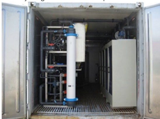
Figuur 4-6. UF-pilot van Pentair op de locatie Elsbeekweg
