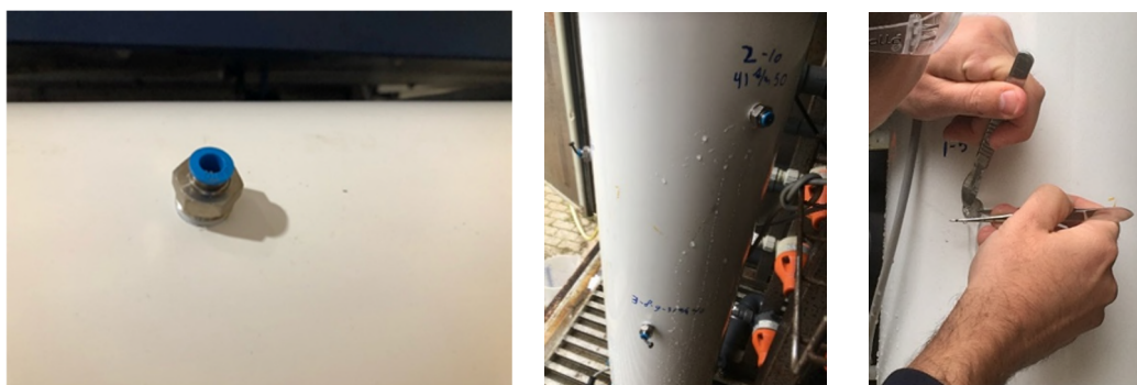
Figuur 4-4. Vezelbeschadiging 9'' UF-module, links: festokoppeling, midden: aangebrachte gaten om vezels te benaderen rechts: doorsnijden vezel
