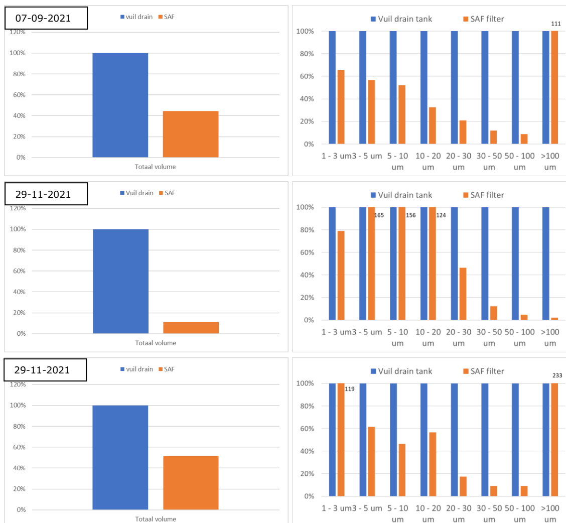
Figuur 3-28 Percentage van het totale volume aan deeltjes (links) en percentage van aantal deeltjes per categorie (rechts) ten opzichte van water uit de vuil draintank na toepassing van het SAF filter op de verschillende meetmomenten.
