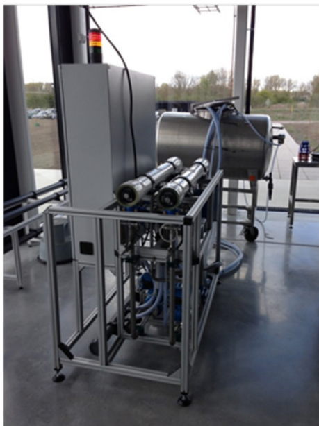
FIGUUR 2-1 4040 TESTBANK MET 2 HORIZONTALE MEMBRANEN
