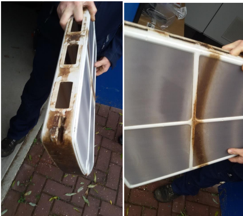
FIGUUR IV-9 ZIJKANT VAN EEN CASSETTE (LINKS): VIERKANTE GATEN ZIJN VOOR HET DOORLATEN VAN DE VOEDING. EFFECT VAN EEN (LANGDURIG) VERSTOPTE SPROEIER (FOTO RECHTS).
