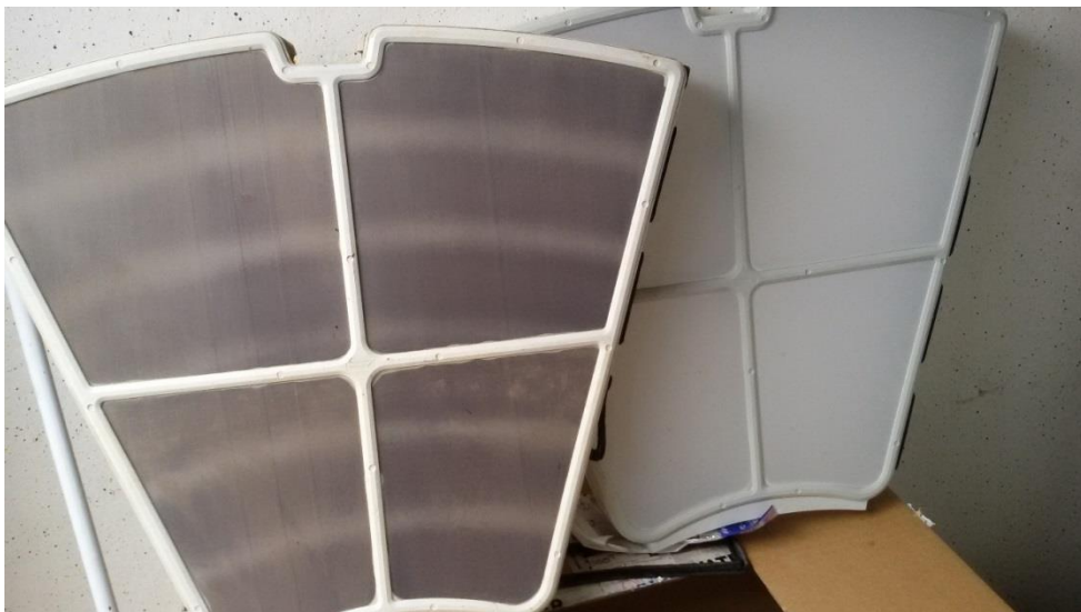
FIGUUR IV-7 GEBRUIKTE (LINKS) EN SCHONE (RECHTS) CASSETTE
