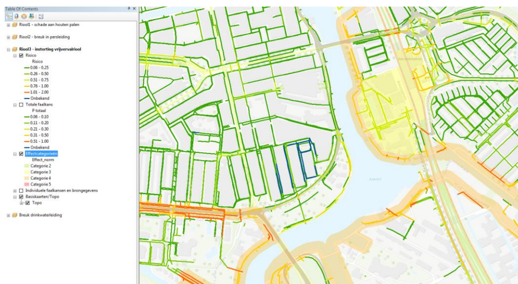
Figuur 4-4 Resultaat van de ongewenste gebeurtenis Schade aan de omgeving door instorting vrijvervalriool.
