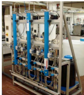
Afbeelding 2. AiRO-opstelling met drie parallelle 2,5 inch SWM RO-elementen bij KWR
