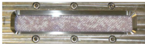
Afbeelding 4. Fijn verdeelde luchtbelletjes tijdens spoelen met lucht en water over de lengte en breedte van het membraan-kanaal
